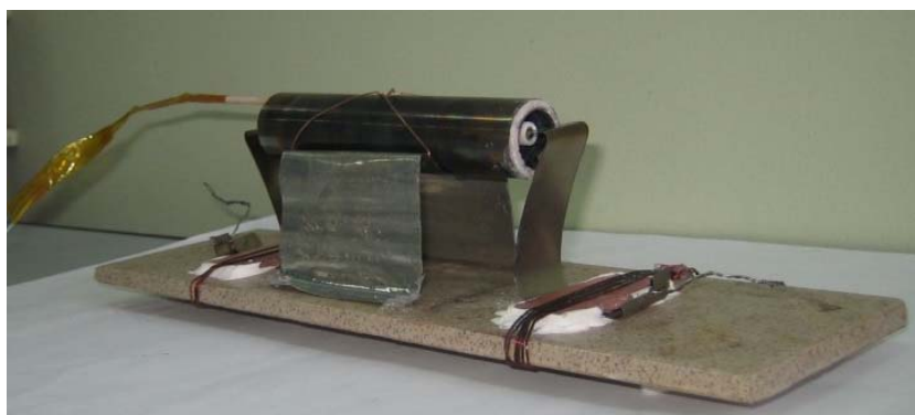
Рис. 3. Галогенная лампа накаливания внутри цилиндрического контейнера
