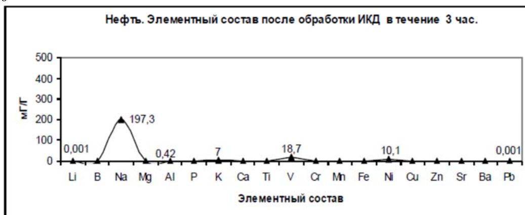
Рис. 2. Исходный состав примесей в сырой нефти (а) и в нефти, экспонированной в течение 3 часов в пучке ИКД (б) (иллюстрация из работы [15])
