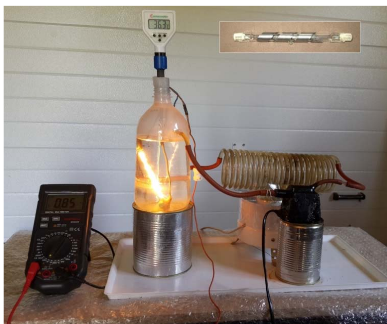
Рис. 7. Галогенная лампа накаливания, обёрнутая лентой из сплава олово–свинец в сосуде с водой. Вода прокачивается через змеевик, охлаждаемый вентилятором
