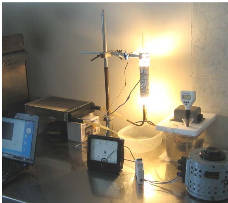
Рис. 6. Экспериментальная установка с циркулирующим раствором \text{KNO}_3 и галогенной лампой накаливания
