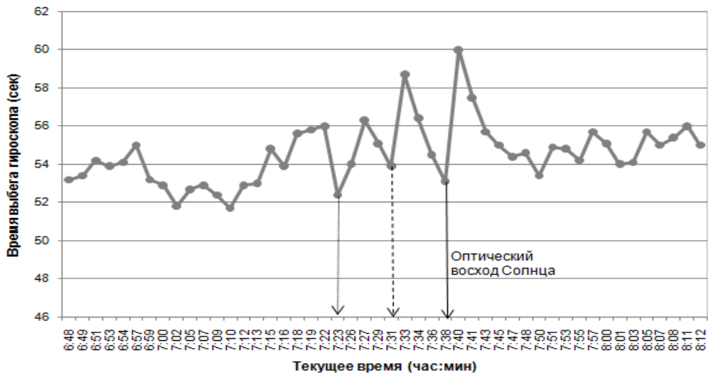
Рис. 6. График хода времени выбега 120 г гироскопа (вращение по часовой стрелке) за 07.03.09 (начало восхода – 7 ч 39 мин)
