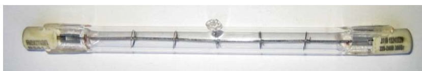
Рис. 2. Галогенная лампа накаливания, использованная в описанных ниже экспериментах
