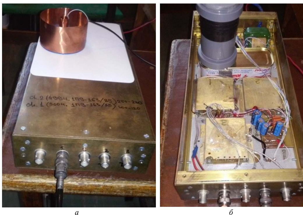
Рис. 2. Блок детекторов альфа-распада и расположение П-излучателя (а); блок детекторов альфа-распада со снятой верхней крышкой (б)
