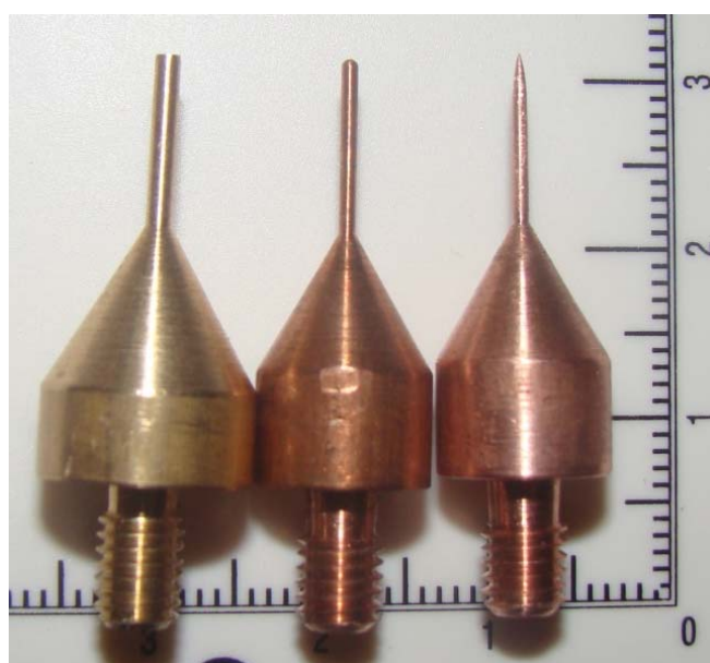
Рис. 5. Формы электродов (сменные аноды), использовавшиеся в эксперименте
