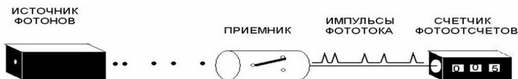
Рис. 1. Схема прямого детектирования
